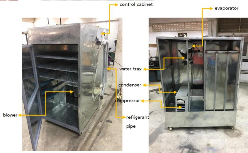
ภาพที่ 1 เครื่องอบแห้งเข้าคลอนด้วยเครื่องอบแห้งแบบปั๊มความร้อน
