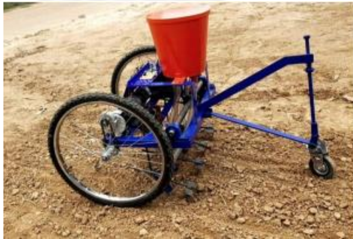
ภาพที่ 4 แสดงโครงสร้างของเครื่องหยอดเมล็ดข้าวเปลือกแบบไร้สายที่ถ่ายจากภาพจริง
