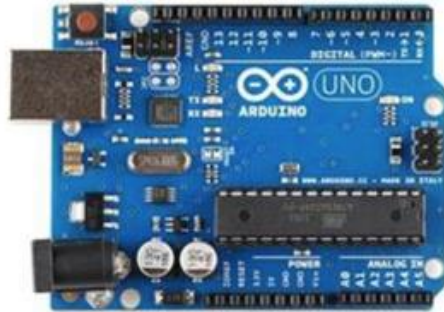
ภาพที่ 2 ตำแหน่งขาสัญญาณต่างๆ ของ Arduino Uno R3 [1]
