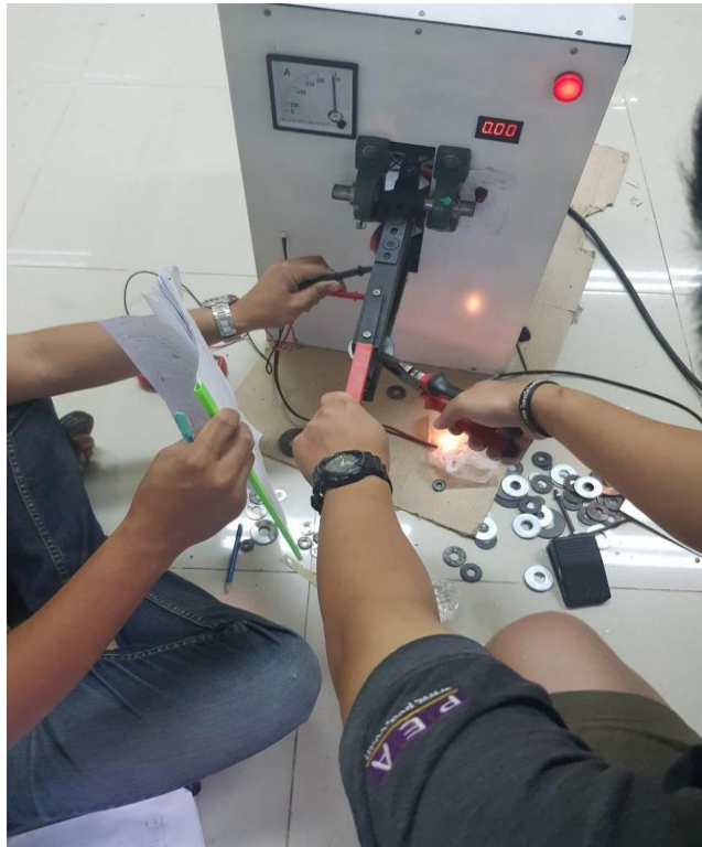
ภาพที่ 9 การทดสอบเชื่อมชิ้นงานตามขนาดเหล็กในขณะทำการทดสอบเชื่อมวงแหวน
