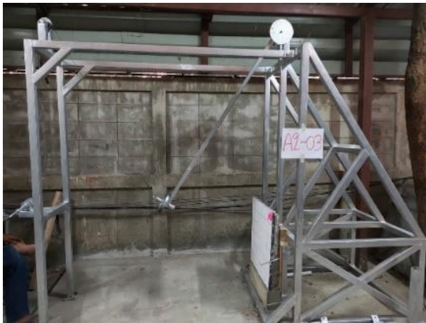
ภาพที่ 3 ชุดเครื่องมือทดสอบเพนดูลัมเทสและการเตรียมตัวอย่างผนังอิฐก่อ
