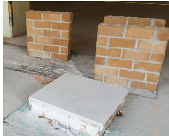
ภาพที่ 3 ชุดเครื่องมือทดสอบเพนดูลัมเทสและการเตรียมตัวอย่างผนังอิฐก่อ
