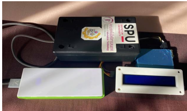
ภาพที่ 4 การต่อวงจรอุปกรณ์ต่างๆ เข้าด้วยกันโดยเราเลือกใช้โปรโทบอร์ด ESP32
