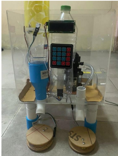
ภาพที่ 4 แสดงอุปกรณ์ให้อาหารสัตว์ประเภทเม็ดแบบอัตโนมัติที่พัฒนา
