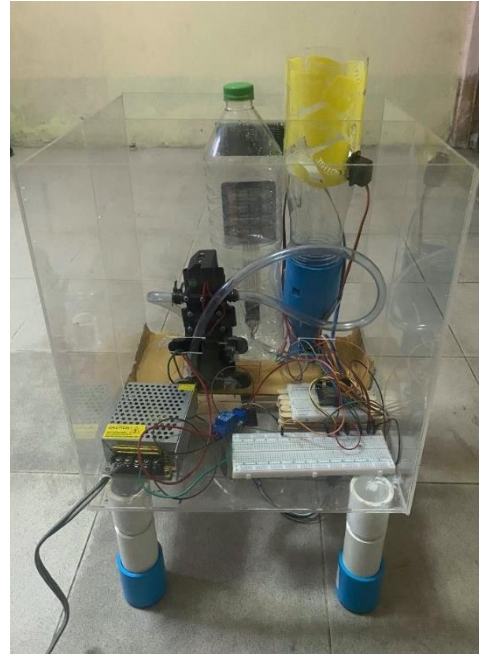
ภาพที่ 4 แสดงอุปกรณ์ให้อาหารสัตว์ประเภทเม็ดแบบอัตโนมัติที่พัฒนา
