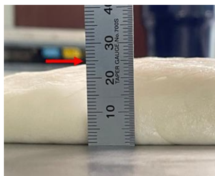
ภาพที่ 4 การกำหนดความหนาของโดก่อนเข้าสู่กระบวนการรีด
