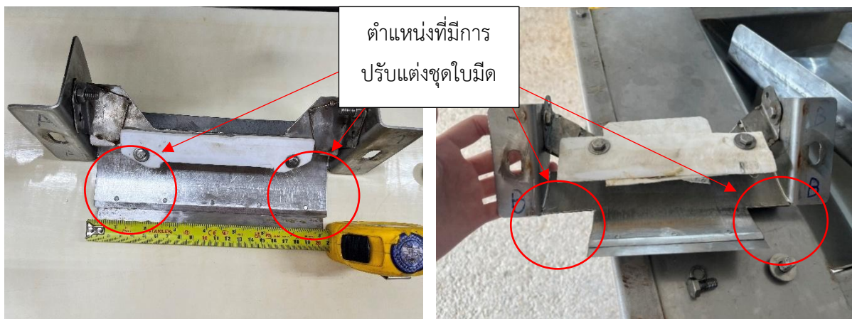
ภาพที่ 5 ชุดใบมีดของเครื่องปอก (ซ้าย) ก่อน และ (ขวา) หลังปรับแต่ง
