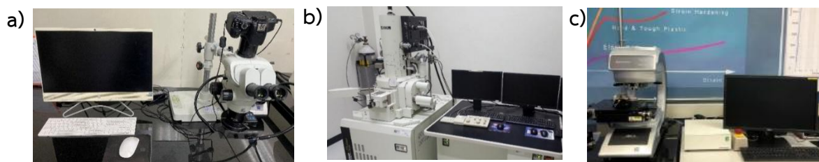
ภาพที่ 6 a) กล้อง Stereo, b) กล้อง Field Emission Scanning Electron Microscope และ c) เครื่องทดสอบความแข็งไมโครวิกเกอร์ส
