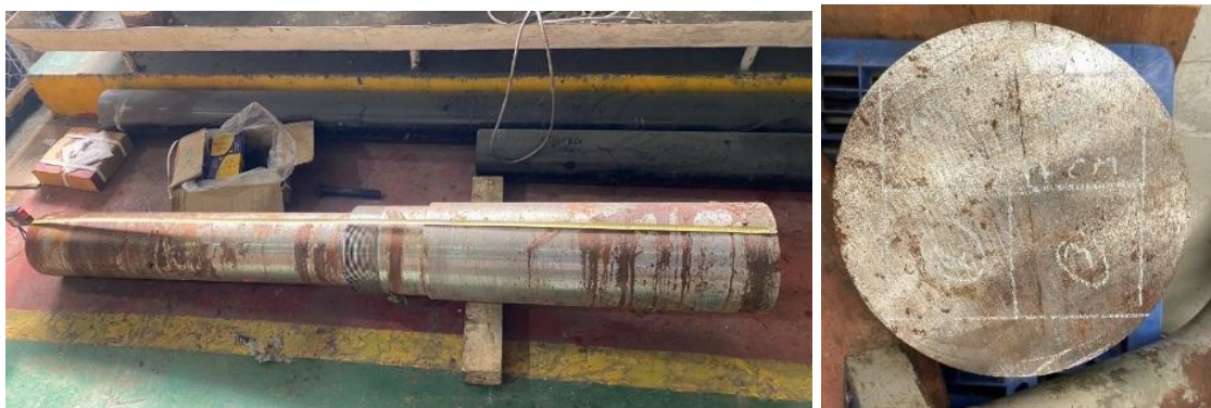
ภาพที่ 1 เฟลาความเร็วสูง เกรด 17CrNiMo6 ที่ใช้ในการทดลอง
