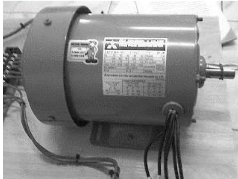
ภาพที่ 6 มอเตอร์เหนี่ยวนำ 3 เฟสที่ถ่ายจากภาพจริง
