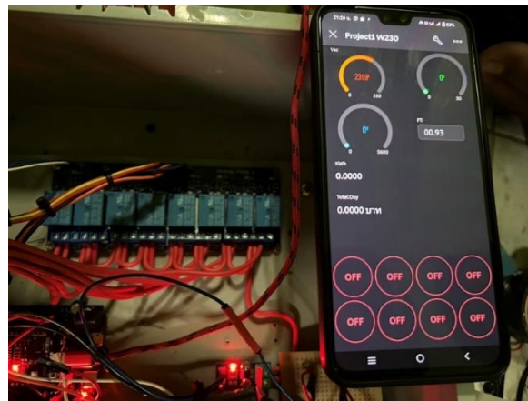
ภาพที่ 6 การทดสอบการปิดหลอดไฟฟ้าผ่านแอปพลิเคชัน Blynk
