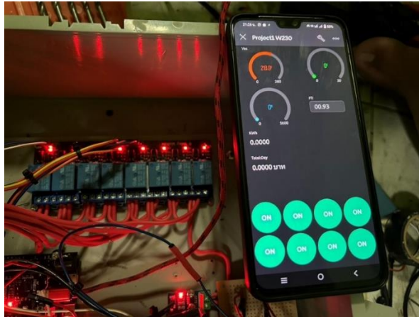
ภาพที่ 5 การทดสอบการเปิดหลอดไฟฟ้าผ่านแอปพลิเคชัน Blynk
