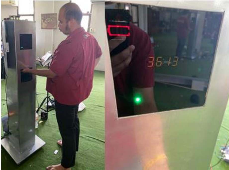
ภาพที่ 4 การทดสอบเครื่องตรวจวัดอุณหภูมิร่างกายพร้อมระบบจ่ายสเปรย์แอลกอฮอล์แบบอัตโนมัติที่ถ่าย จากภาพจริง
