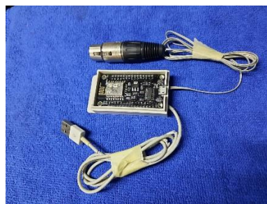
ภาพที่ 4 การต่อสายสัญญาณกับบอร์ด
