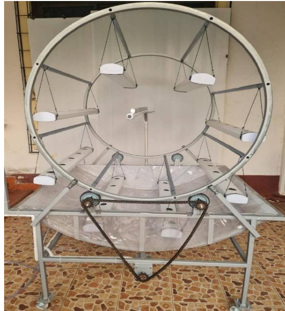
ภาพที่ 5 การติดตั้งโครงสร้างระบบอัตโนมัติสำหรับการปลูกพืชแบบหมุน
