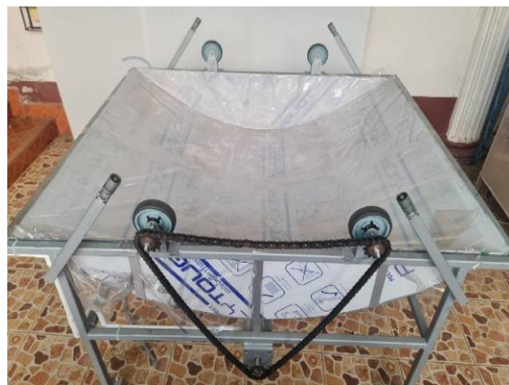
ง. ส่วนฐานติดตั้ง มอเตอร์และโซ่ในการขับเคลื่อน
