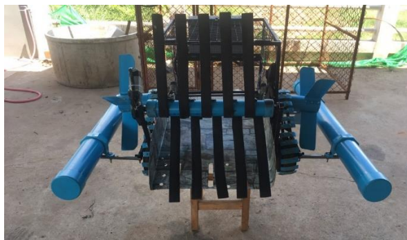
ภาพที่ 3 โครงสร้างหุ่นยนต์เก็บขยะสะเทินน้ำสะเทินบกแบบไร้สายที่ถ่ายจากภาพจริง
