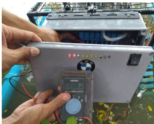
ภาพที่ 6 การทดสอบหุ่นยนต์เก็บขยะสะเทินน้ำสะเทินบกแบบไร้สายที่ถ่ายจากจริง
