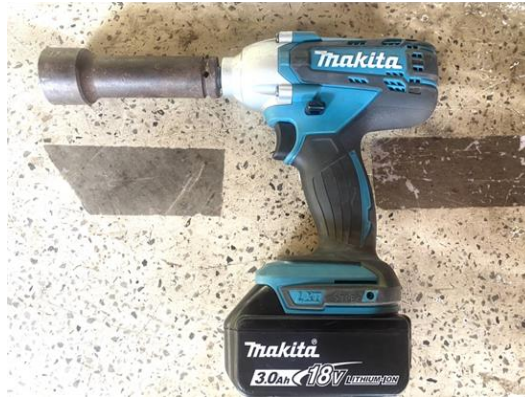
ภาพที่ 7 การประกอบบล็อกจิ้งจกชื้นเนื้อเอ็ม 16 กับส่วนต้นกำลัง
