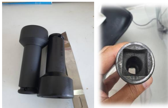
ภาพที่ 6 บล็อกขันน็อตเอ็ม 16 ทางซ้าย รูปทรงบล็อก , ทางขวา ส่วนที่ใช้ขันน็อตเอ็ม16
