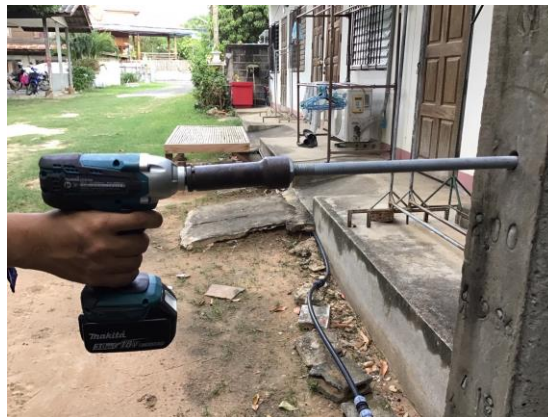
ภาพที่ 8 การทดสอบใช้งานบล็อกจิ้งจกชื้นเนื้อเอ็ม 16
