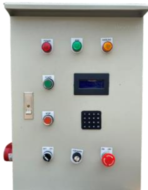
ก. ด้านหน้าตู้ควบคุมเครื่องหมักปุ๋ยแบบหมุน
