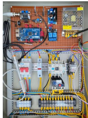
ข. ด้านในตู้ควบคุมเครื่องหมักปุ๋ยแบบหมุน
